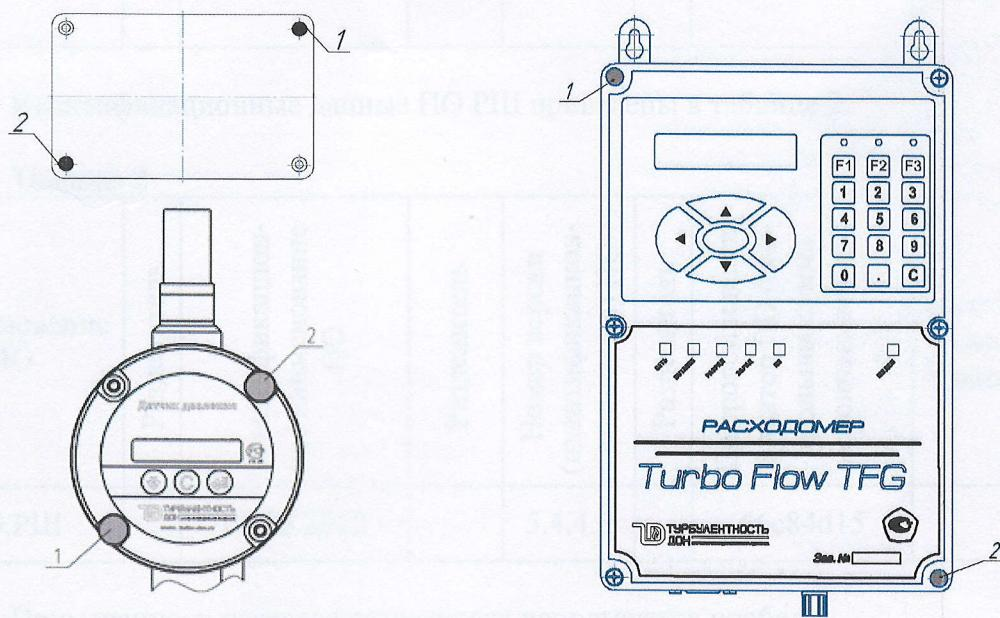
Рисунок 1. Схема пломбирования ПП и РШ расходомера
